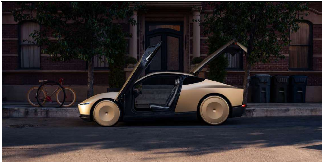
圖 20: Cybercab 採雙門鷗翼設計，且無配備方向盤、電門以及後擋風玻璃
