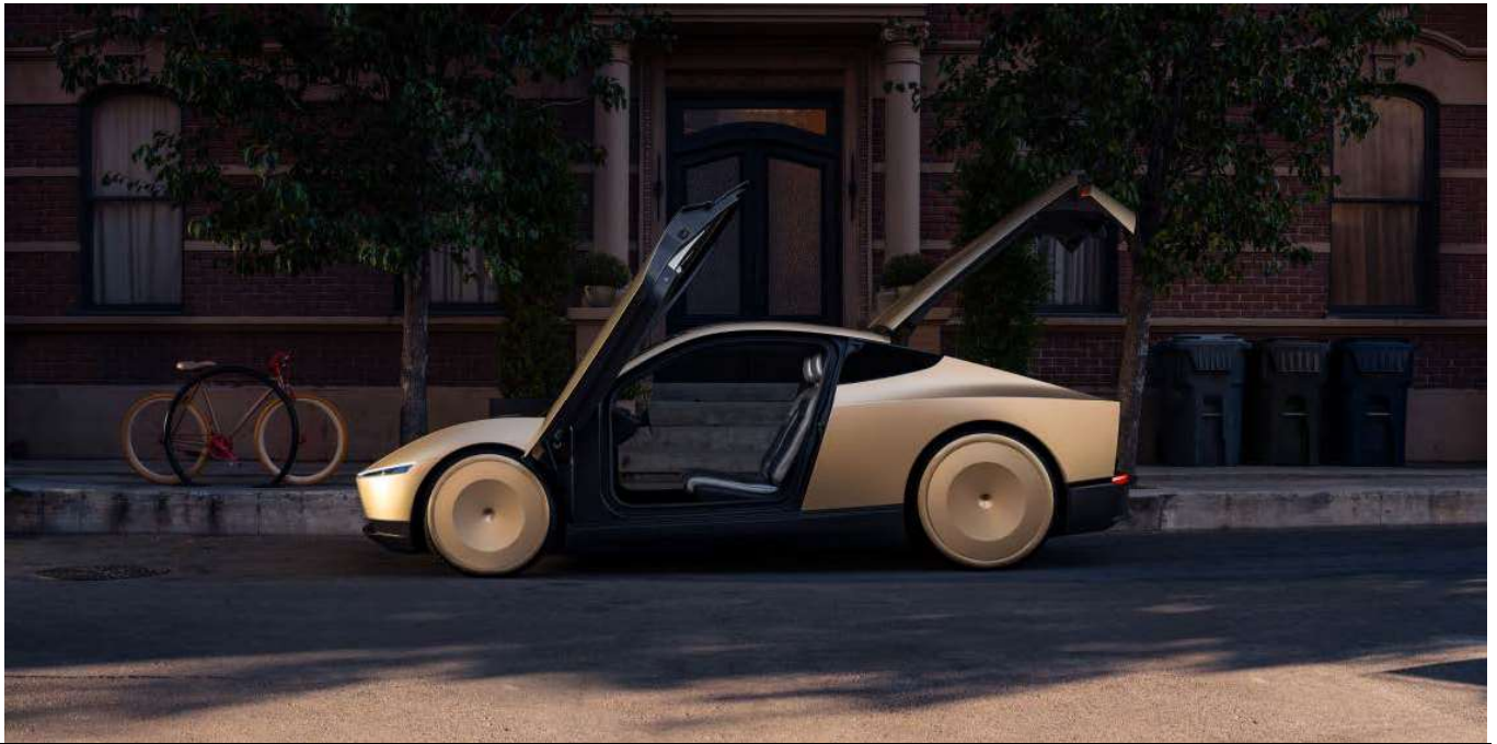
圖 16: Cybercab 採雙門鷗翼設計，且無配備方向盤、電門以及後擋風玻璃
