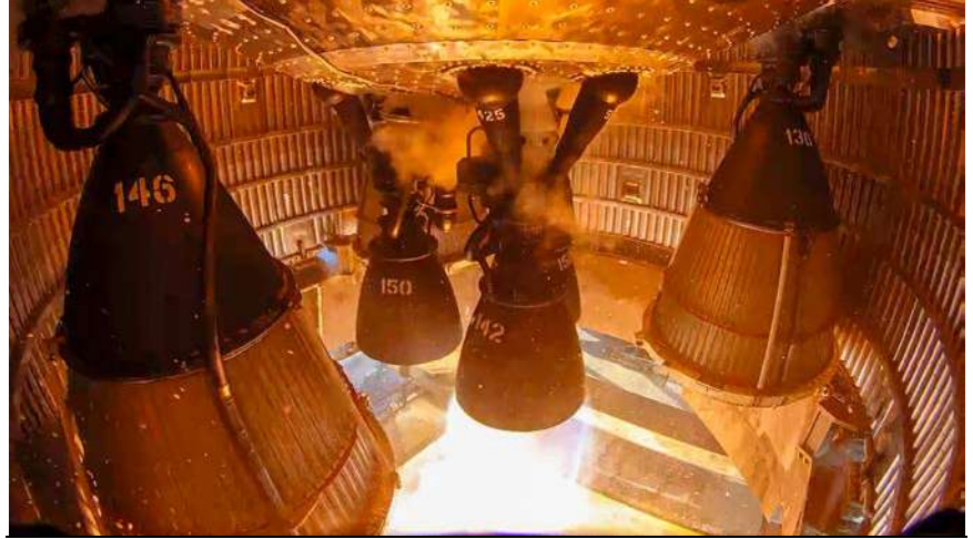
圖 2：SpaceX 已完成對 Raptor 3 火箭引擎的靜態點火測試
