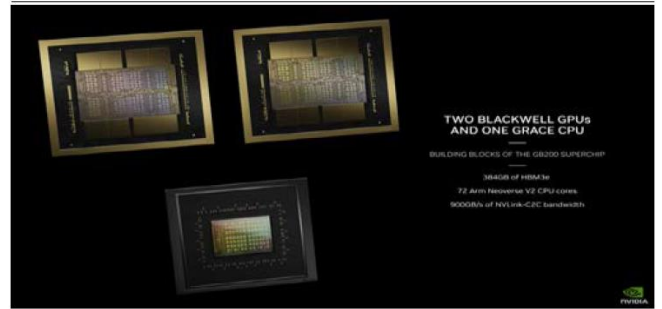
圖 8: 由兩個 Blackwell GPU 和 1 個 Grace CPU 組成
