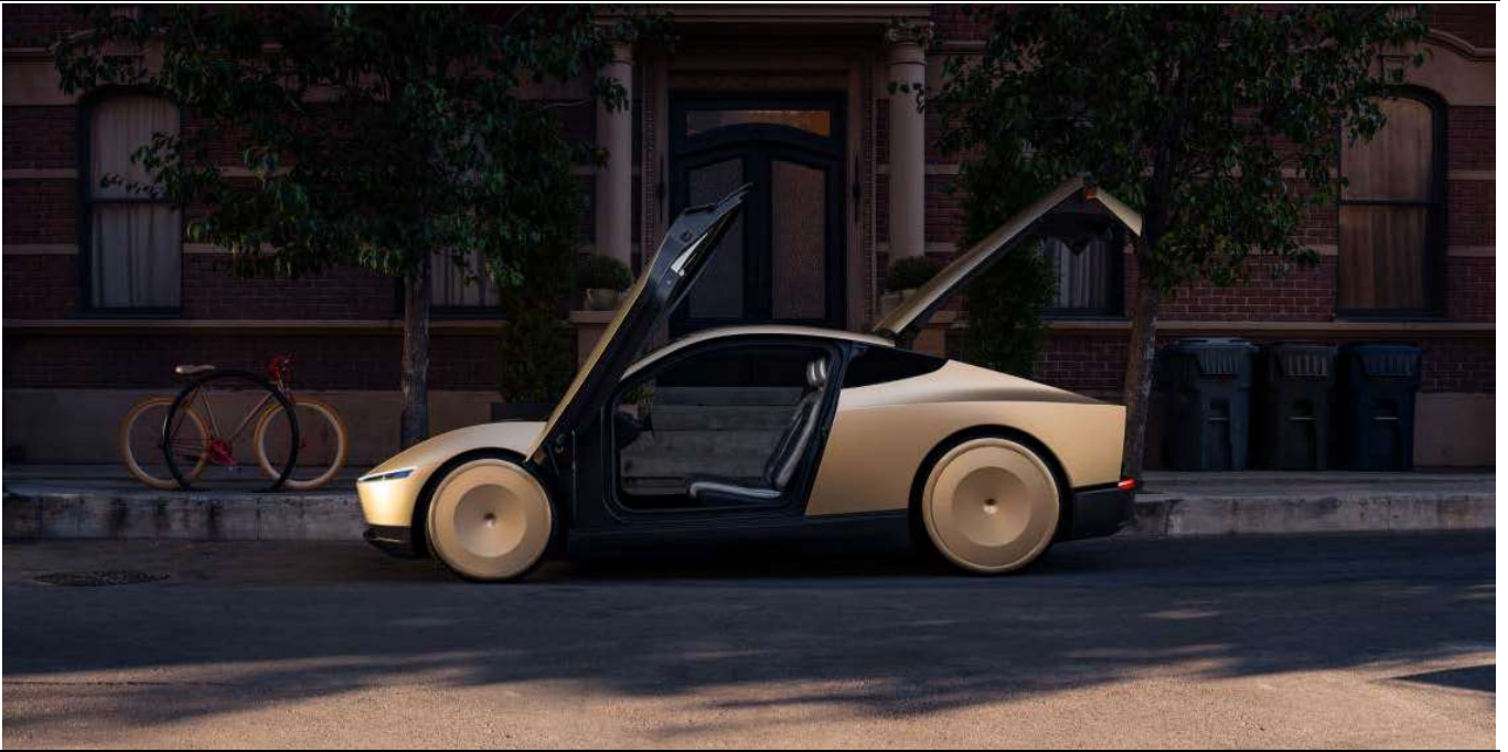
圖 19: Cybercab 採雙門鷗翼設計，且無配備方向盤、電門以及後擋風玻璃
